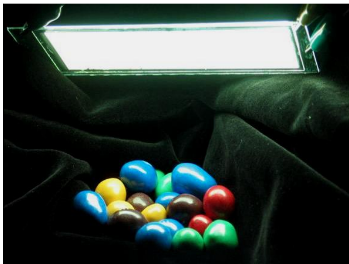
Piastrella per illuminazione con superficie attiva di 35 cm 2 facente uso di un copolimero a emissione di luce bianca (Immagine fornita da Siemens)
