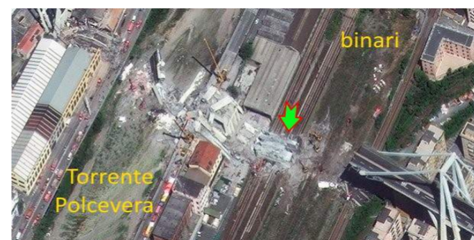
Vista da sud di tutti gli elementi crollati: a sinistra, le parti cadute sul Polcevera; a destra, le parti crollate sui binari
