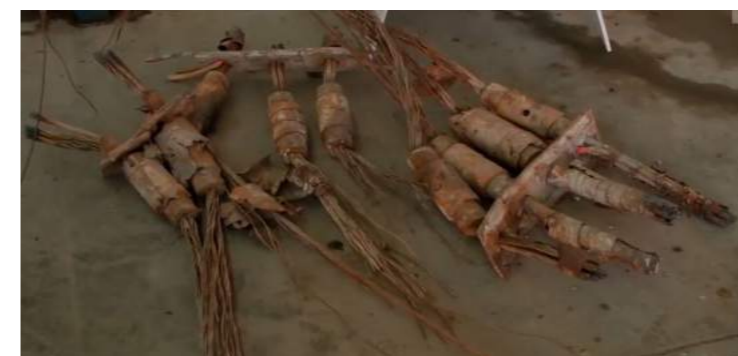
Foto 8. Ferri strettamente ammorsati ai manicotti
