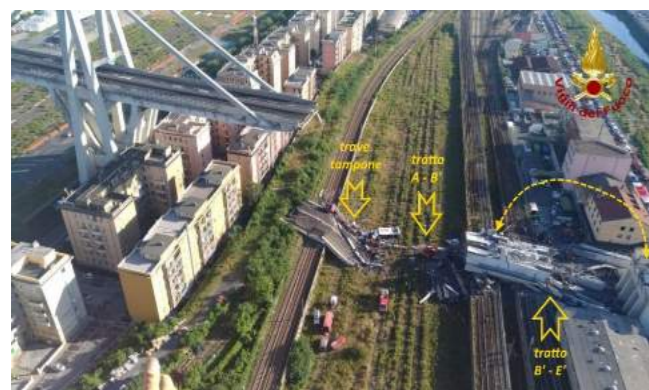
Traslazione tratto A'-B' e rotazione di 180° del tratto B'-E'
