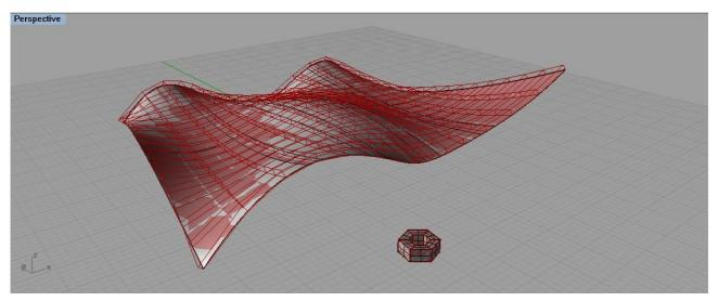
nel quale possiamo vedere i parallelepipedi (o box) distribuiti e deformati (morphed) lungo la superficie.
